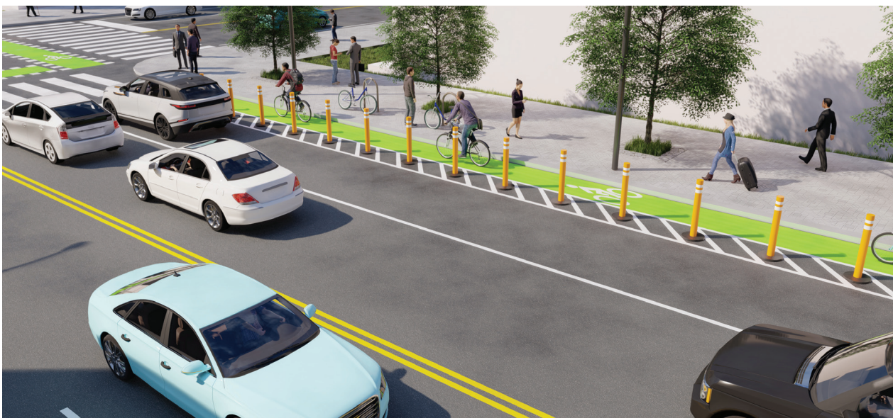
Зураг 12.2. Тусгаарлах зурвас, чиглүүлэх хэрэгслээр хамгаалагдсан унадаг дугуйн замын харагдах байдал
