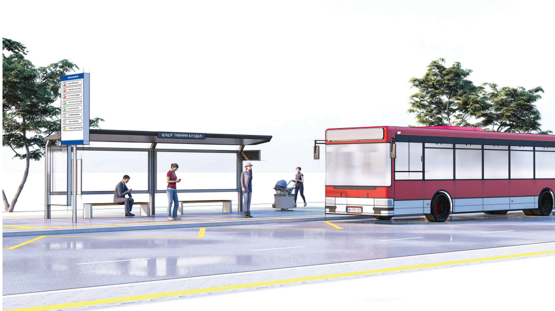
Зураг 7.1. Зорчих хэсэг дээрх автобусны зогсоолын хэвтээ тэмдэглэгээ (Жишээ)
